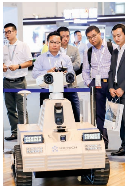
ZDALNIE STEROWANE POJAZDY O WZMOCNIONEJ KONSTRUKCJI UMOZLIWIĄJĄ PRZEPROWADZENIE INSPEKCJI (W TYM ANALIZĘ OBRAZU WYSOKIEJ ROZDZIELCZOŚCI W CZASIE RZECZYWISTYM) W NIEBEZPIECZNYCH MIEJSCACH.
